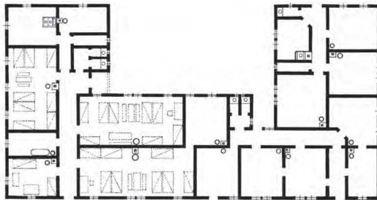
Fig. 82) Gendarmeria e abitazione. Un edificio posto a pianoterra, avente forma di lettera "U", di dimensioni 34,85 x 9,7 m, con due ali di dimensioni 9,7 x 8,3 m. Era costituito da tre camere da letto per otto persone, nove appartamenti, una camera per il cuoco, un ufficio per la guardia di turno, due cucine con dispense, due servizi igienici con due cabine, un bagno, due corridoi e sei ingressi. La parte sinistra dell'edificio era stata adattata alle esigenze del servizio, mentre la parte centrale destra era funzionale alla permanenza delle persone che erano fuori servizio / Žandarmerija i spavaonice. Prizemnica, oblika slova "U", dimenzija 34,85 x 9,7 m s dva krila dimenzija 9,7 x 8,3 m. Sastoji se od tri spavaonice za po osam osoba, devet soba, sobe za kuhara, kancelarije dežurnog čuvara, dvije kuhinje sa ostavama, dva sanitarna čvora s po dvije kabine, kupatila, dva hodnika i šest ulaza. Lijevi dio objekta prilagođen je potrebama službe, dok je srednji i desni dio prilagođen za boravak osoba izvan službe.
