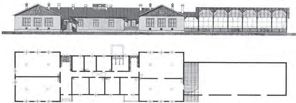
Fig. 100) Ospedale No. 14, ospedale infantile: di dimensioni esterne 45,9 x 13,6 m, superficie di 576,73 m 2 . Le parti sinistra e destra contenevano due camere per degenza con una capacità di 60 bambini. Nella parte centrale, trovavano posto servizi in comune: un bagno, un gabinetto, una cucina, un ambulatorio e una sala d'attesa. Negli spazi relativi all'ala sinistra, venne allestita una sala giochi di dimensioni 28 x 9 m e di superficie 252 m 2 / Bolnica br. 14, dječja bolnica. Vanjskih dimenzija 45,9 x 13,6 m, te površine 576,73 m 2 . U lijevom i desnom krilu objekta nalaze se po dvije sobe za smještaj ukupno 60 djece. U središnjem dijelu nalaze se zajednički sadržaji: kupatilo, wc, kuhinja, doktorska ordinacija i čekaonica. U produžetku desnog krila nalazi se igraonica dimenzija 28 x 9 m i površine 252 m 2 .
