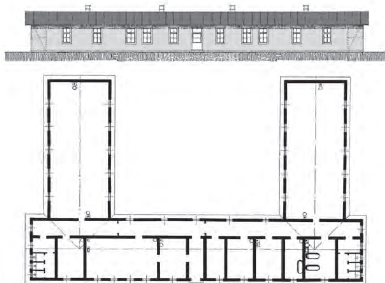
Fig. 61) Ospedale No. 10, per le malattie interne. Era composto da una parte centrale, di dimensioni 42,6 x 8 m, ove si trovava tutta la struttura ospedaliera, due bagni, ambulatori, uffici dei medici, cucine, come pure due servizi igienici separati. Verticalmente sulla struttura centrale si trovavano due locali di dim. 18 x 8 con un totale di 50 letti / Bolnica br. 10, za interne bolesti. Sastojala se od centralnog dijela, dimenzija 42,6 x 8m, gdje je bila smještena sva bolnička struktura, dva kupatila, ambulante, ordinacije, kuhinje, kao i dva odvojena sanitarna čvora. Okomito na središnji objekt nalazile su se dvije prostorije dim. 18 x 8m s ukupno 50 kreveta.
